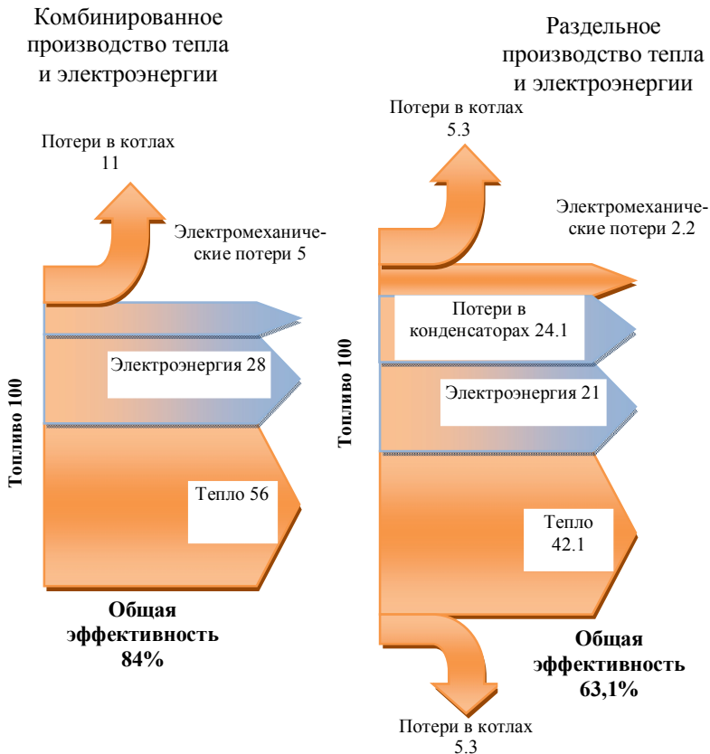
Рис. 1. Преобразование энергии в традиционных и когенерационных установках
